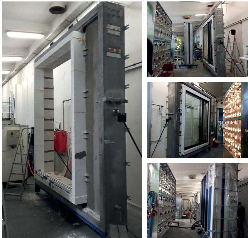
Prüfungen auf Dichtheit und Haltbarkeit der Lösung im ITB-Labor in Warszawa.
